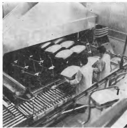
Fig. 2 - In questo forno continuo del quale vediamo l'uscita, avviene la saldatura tra il pannello frontale ed il cono del cinescopio. Tale operazione è assai delicata e dalla sua buona riuscita dipende la vita del cinescopio.
